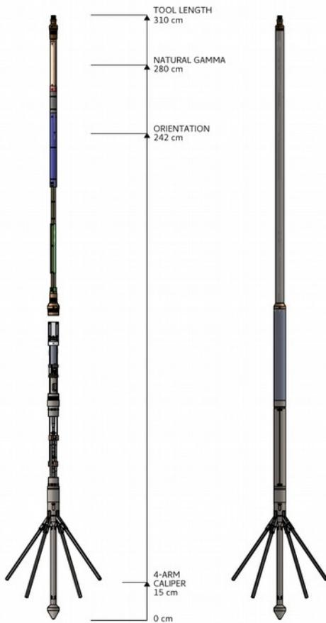
Зонд 4АС60 для измерения геометрии скважины оснащен двумя парами щупов, делающих независимые перпендикулярные X-Y замеры диаметра скважины. Вместе с тем система магнитометр/акселерометр выдает азимут, наклон скважины и направления щупов X-Y.
