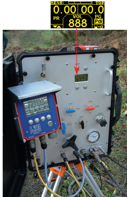
Digital Ménard pressuremeter EN ISO 22476-4
