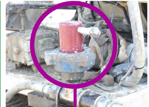
**Separador de membrana:** instalado en la línea de inyección de lechada para medición de presión y flujo/volumen.
