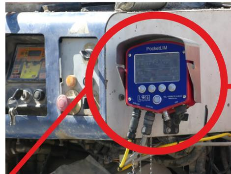
**PocketLIM:** Visualización central y registro de parámetros de perforación y jet grouting. Los valores y gráficos se basan en la profundidad. El sistema también ofrece la posibilidad de controlar automáticamente el ascenso durante la fase de chorro.
