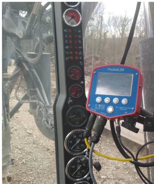
PocketLIM instalado en una cabina EPIROC
