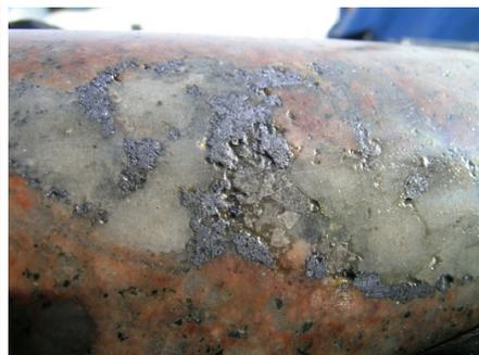
Fotografías de núcleos que muestran la mineralización típica de calcopirita (izquierda) y molibdenita (derecha) encontrada en este pozo.
