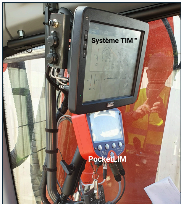
Los dos sistemas TIM™ y PocketLIM instalados en la cabina del taladro Sandvik Ranger™ DX900i
