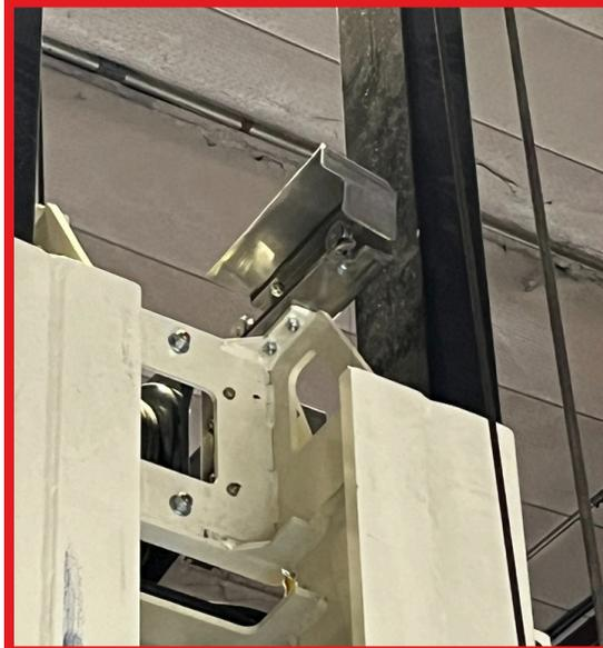
**Codificador de profundidad instalado por Geoprobe:** Este es el frente del mástil. Hay una cuerda atada al cabezal de perforación. Cuando el cabezal de perforación desciende, registramos la profundidad y la penetración.
