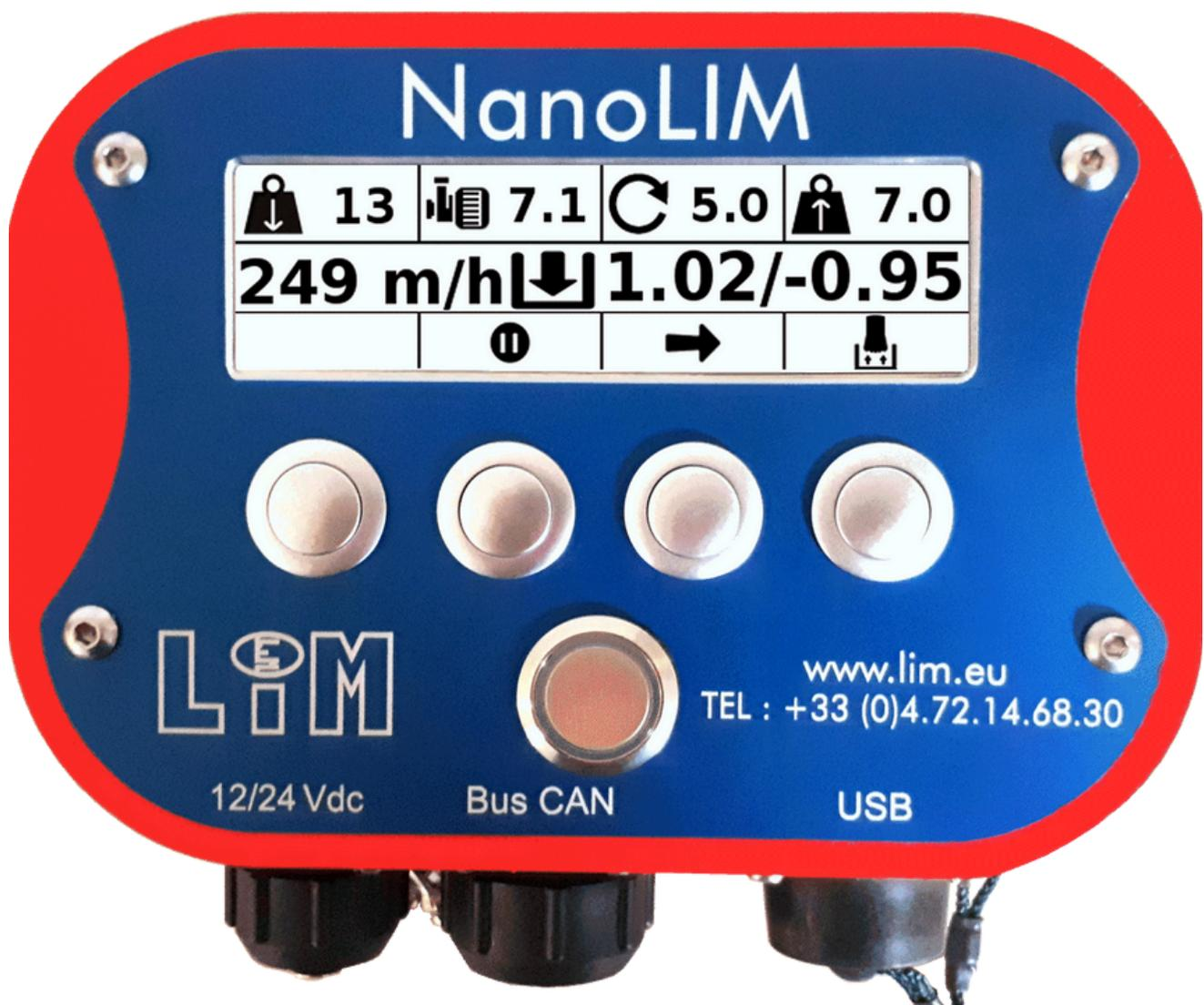
El NanoLIM 5G es una unidad de adquisición de datos LIM simplificada de última generación limitada a los siguientes parámetros de perforación que se registran en función de la profundidad:
