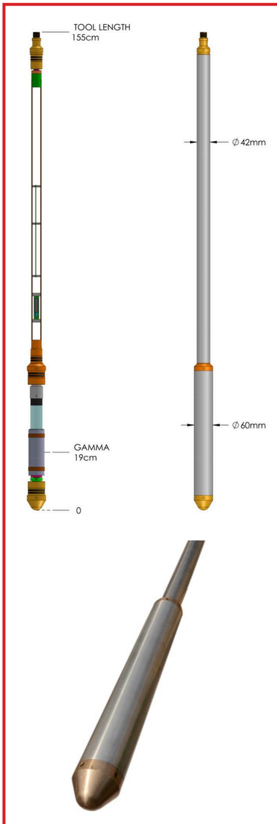
El dispositivo de detección está compuesto por un cristal NaI cilíndrico de 25 x 50 mm (GRS42) o 50 x 150 mm (GRS60) acoplado a un tubo fotomultiplicador estabilizado térmicamente.
