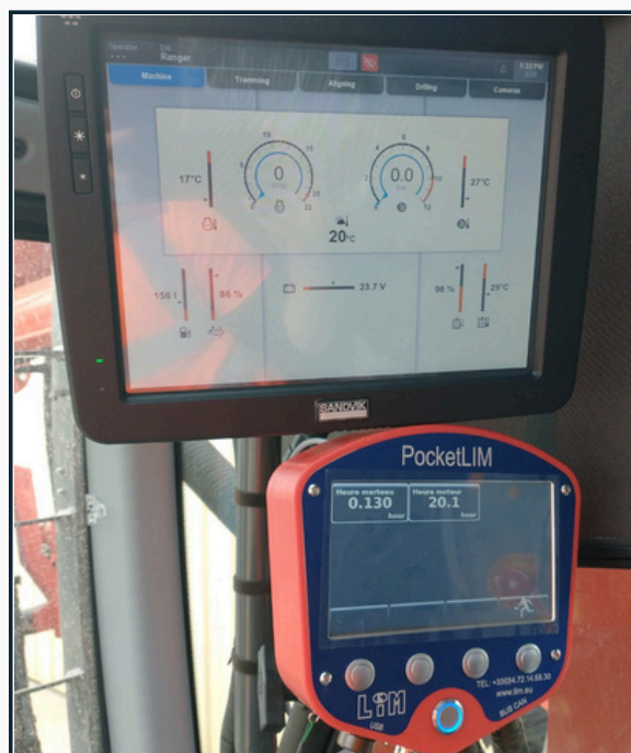
Les deux systèmes TIM™ et PocketLIM installés dans la cabine de la foreuse Sandvik Ranger™ DX900i
