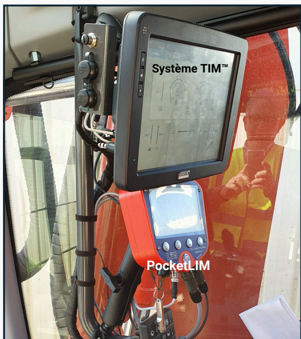
Les deux systèmes TIM™ et PocketLIM installés dans la cabine de la foreuse Sandvik Ranger™ DX900i
