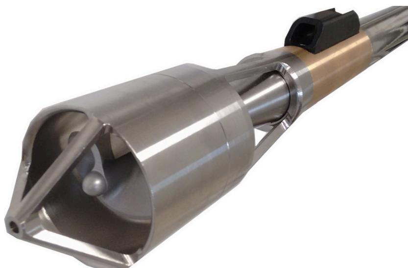
La photo ci-contre montre la partie inférieure de la sonde **FTC60** avec le micro-moulinet et le capteur de température/conductivité monté sur le corps de l'outil juste au-dessus.
