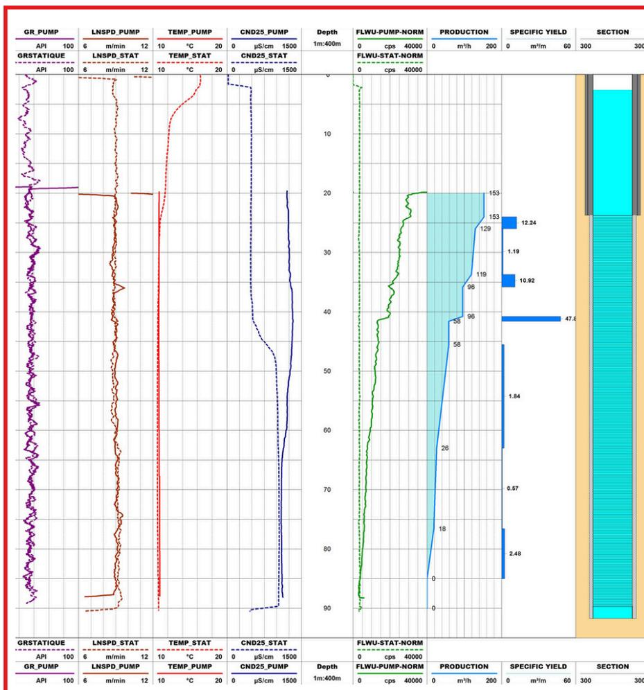
La sonde **FTC60G** a été utilisée pour établir un profil de production dans un forage dans un but d'assèchement (arrêt d'exploitation), sur un site situé dans l'est de la France.
