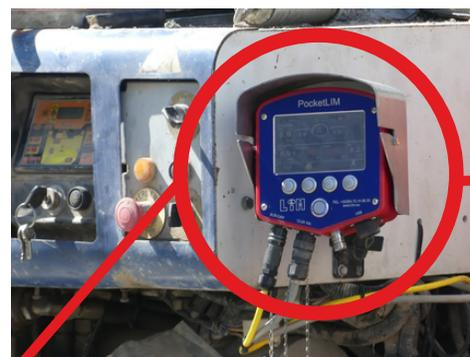
PocketLIM: Centrale d'affichage et d'enregistrement de paramètres de forage et de jet grouting. Les valeurs et les graphiques sont en fonction de la profondeur. Le système offre aussi la possibilité de contrôler automatiquement la remontée durant la phase de jet.
