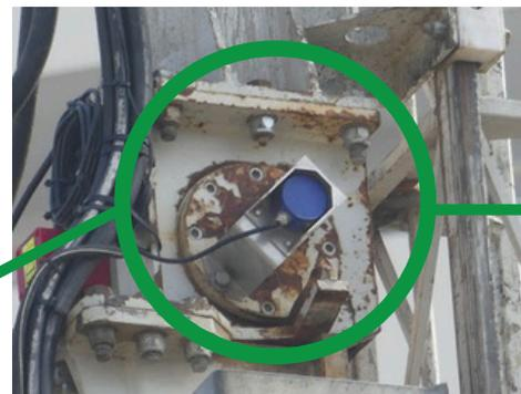
Capteur profondeur/vitesse: Codeur optique qui mesure la profondeur et les vitesses de pénétration et de remontée. Le codeur est couplé à l'axe tournant du pignon de la chaîne. Des solutions alternatives existent pour une adaptation à tout type de foreuses hydrauliques.
