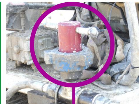
Séparateur à membrane: installé sur la conduite d'injection du coulis pour la mesure de la pression et du débit/volume.
