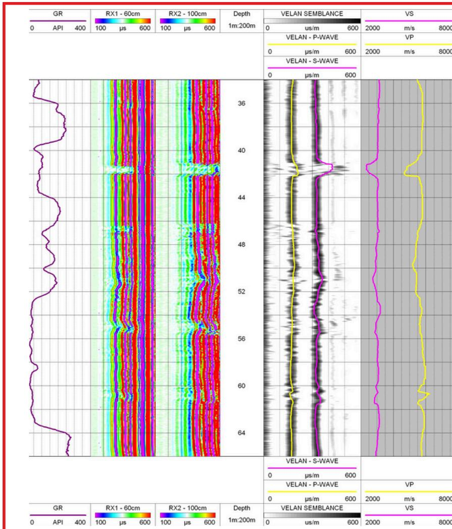
L'exemple de diagraphie présenté à gauche a été enregistré dans un forage effectué dans une séquence de formations métamorphiques des Alpes françaises dans le cadre d'une étude géotechnique. Le forage est incliné de plus de 45 ° par rapport à la verticale.
