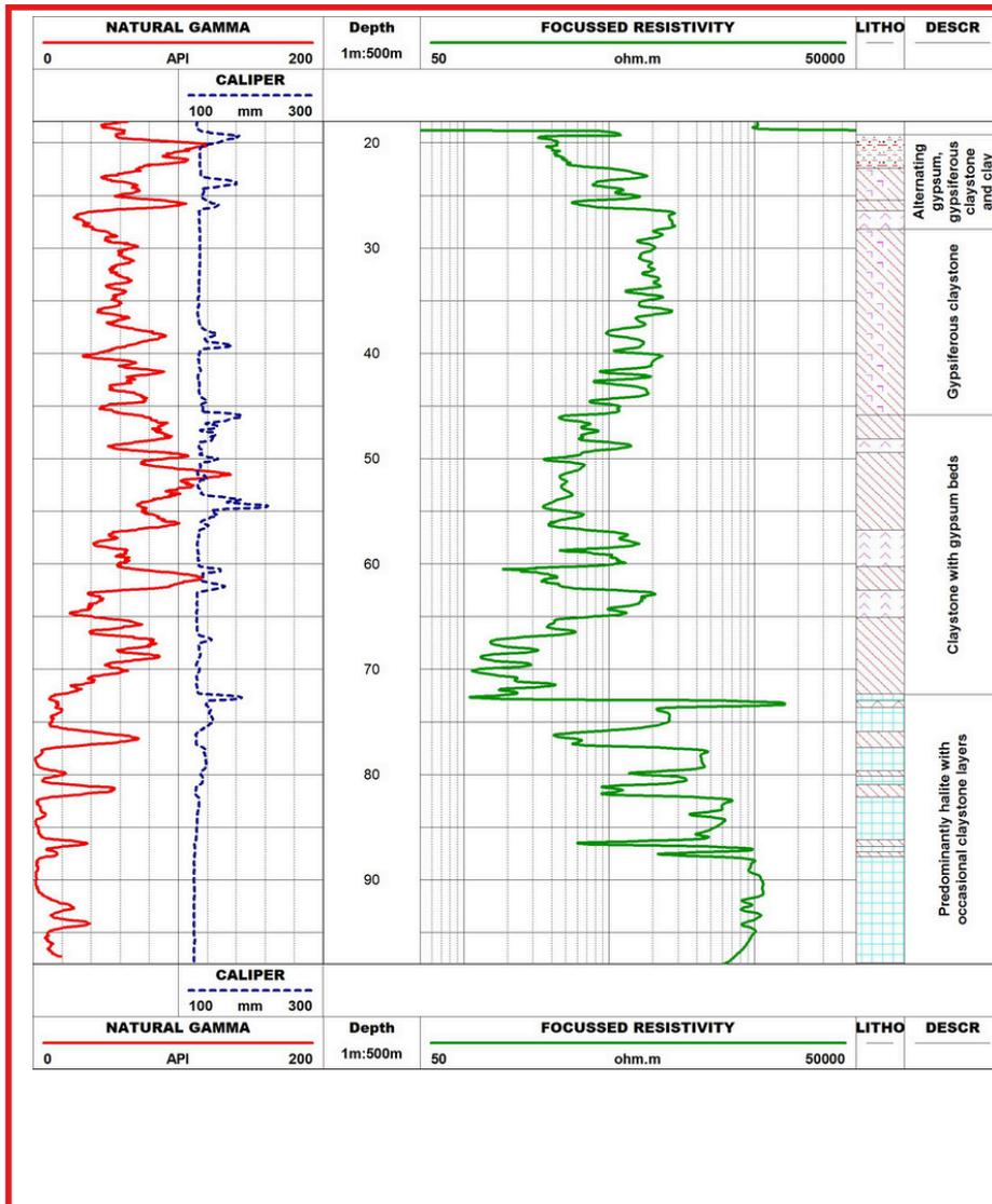
L'exemple de diagraphie présenté à gauche a été enregistré dans un forage foré en diamètre "PQ" dans le cadre d'une enquête géologique et hydrogéologique réalisée en Alsace (France) dans une région faillée où des problèmes d'affaissement du sol sont rencontrés. On pense que ces problèmes sont liés à l'interaction des eaux souterraines avec les nombreux horizons évaporitiques proches de la surface.
