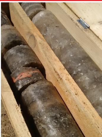
Photographie de carottes montrant niveaux de halite massifs présents dans la partie inférieure de la section forée (à gauche).
