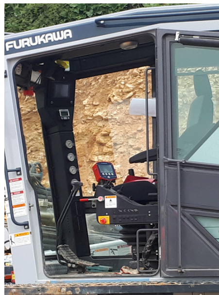
PocketLIM installé dans une cabine FURUKAWA
