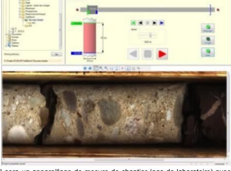
Ce matériel sera un appareillage de mesure de chantier (pas de laboratoire) avec une finalité de digitaliser des images avec une grande précision et de donner des informations de teneurs des minerais recherchés sur carottes de forages pour des teneurs des minerais recherchés supérieurs à 0,1 % et cela au plus prés du lieu des forages sans transport des carottes.
