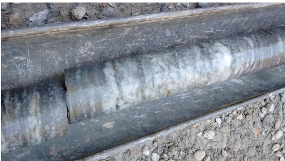
Le forage a traversé des roches métamorphiques très dures et abrasives (méta-calcaires, gneiss à multiples veines de quartz et horizons riches en quartz), la photo ci-contre montre un échantillon type de carotte.
