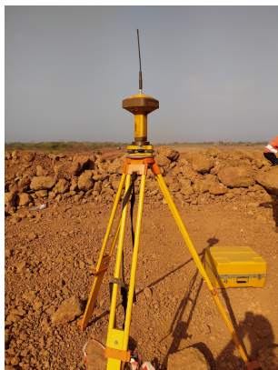
Antenne de base fixe émettant la correction GPS RTK.
